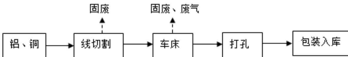
图 3-3 本项目生产工艺流程图
