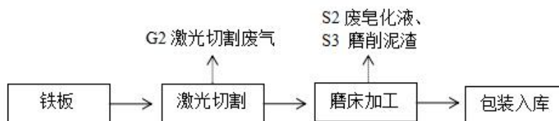
图 3-3 本项目生产工艺流程图
