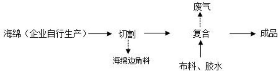
图 3-3 本项目生产工艺流程图
