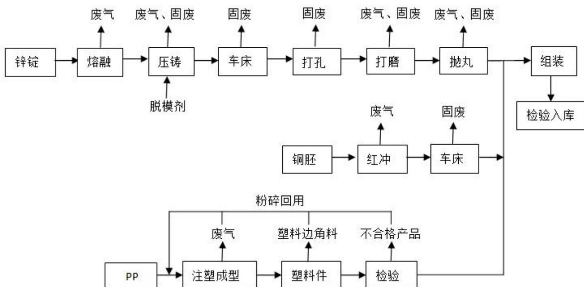
图 3-3 本项目生产工艺流程图
