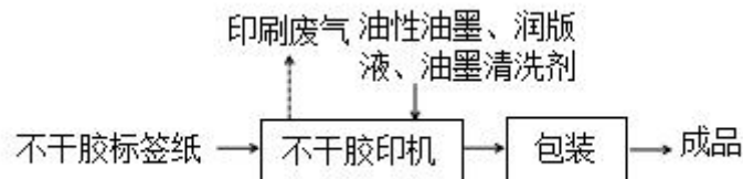
图 2-2 不干胶生产工艺流程及产污节点图
