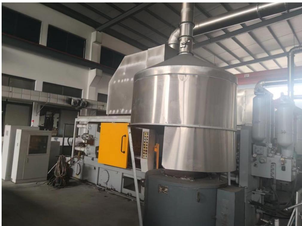
熔化炉以及压铸机
