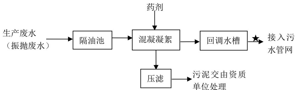
图 3-1 废水处理工艺流程图
